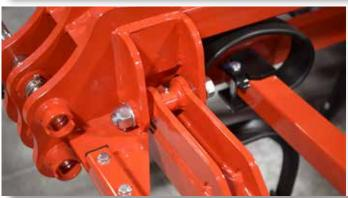
GREASEABLE JOINTS WITH HARDENED BUSHINGS
